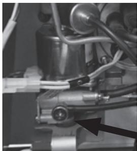
Wenn die Brennstoffpumpe des Heizgeräts außergewöhnlich laut ist und das Heizgerät nicht richtig läuft, ist die Ursache wahrscheinlich Luft im Brennstoffsystem.
