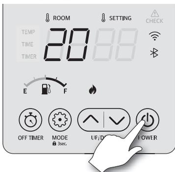
2. Die entsprechende Signalleuchte leuchtet, wenn der Thermostatbetrieb gewählt ist. Um vom Thermostatbetrieb in den Timerbetrieb zu wechseln, drücken Sie die Taste MODE.
