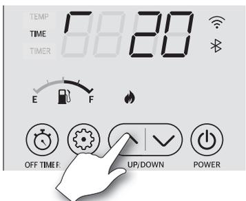
4. Die Betriebszeit kann zwischen 10 und 55 Minuten eingestellt werden, oder die Heizung kann auf Dauerbetrieb eingestellt werden. Nach Beendigung des Betriebszyklus unterbricht das Heizgerät den Betrieb immer für fünf (5) Minuten. Auf dem Display werden neben der Betriebszeit zwei Striche (-) angezeigt, um die Pause anzuzeigen.
