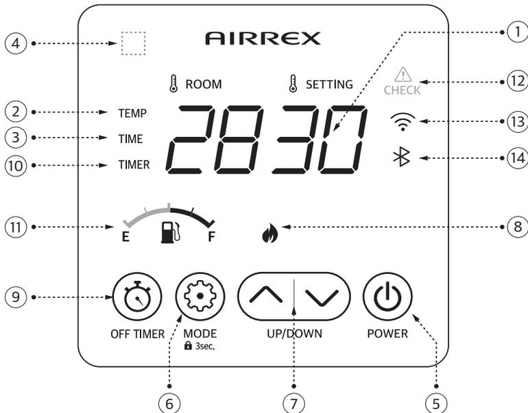
**1. LED-DISPLAY** Das Display kann zur Kontrolle von Temperatur, Timer, Fehlercodes usw. verwendet werden.
