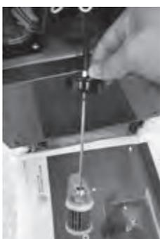
Der Kraftstofffilter befindet sich im Heizgerätetank. Der Filterwechselzyklus wird für 6 Monate empfohlen. (Abhängig von der Kraftstoffqualität.)
