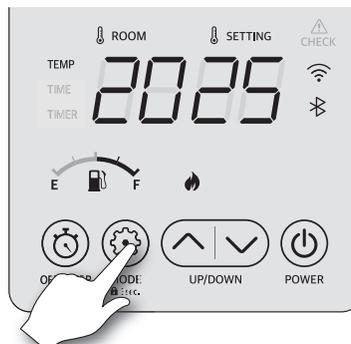
3. Wenn der Timer-Betrieb eingeschaltet ist, wird links ein Leuchtring angezeigt. Auf der rechten Seite wird die eingestellte Betriebszeit (in Minuten) angezeigt. Wählen Sie mit den Pfeiltasten die gewünschte Betriebszeit. Die ausgewählte Zeit blinkt auf dem Display. Wenn die Pfeiltasten drei (3) Sekunden lang nicht gedrückt werden, wird die auf dem Bildschirm angezeigte Zeiteinstellung aktiviert.
