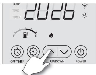
4. Nach dem Einschalten wird das Heizen automatisch aktiviert, wenn die aktuelle Temperatur um zwei (2°C) Grad unter die Zieltemperatur fällt. Dementsprechend wird das Heizgerät deaktiviert, wenn die aktuelle Temperatur um ein Grad (1°C) über die eingestellte Solltemperatur ansteigt.
