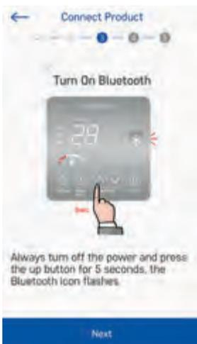
6. Schalten Sie das Heizgerät aus und drücken Sie die Aufwärtstaste 5 Sekunden lang. Anschließend blinkt die Bluetooth-Leuchte. Drücken Sie die Taste **WEITER** in der App.
